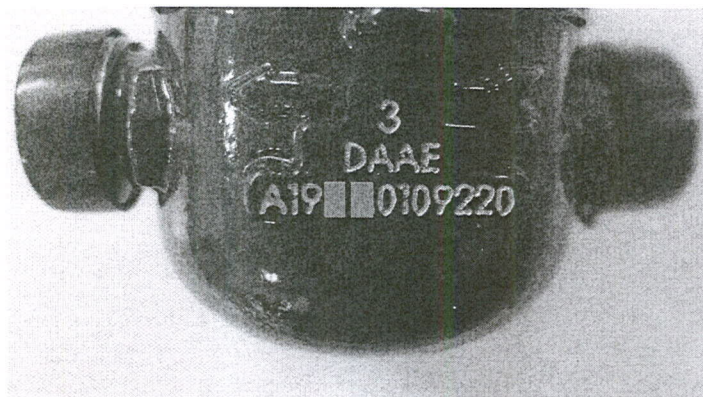
Foto 01 – Detalhe da inserção da sigla DAAE na carcaça do MEDIDOR.
